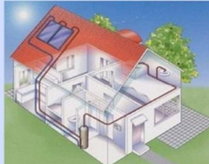
**Слънчевите колектори** служат за осигуряване на битова топла вода, както през летните, така и през зимните дни.
